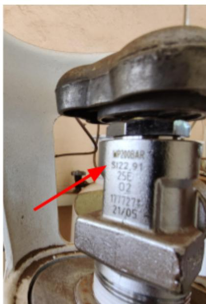
A designação "SI 22.91" refere-se ao diâmetro exterior e à forma da rosca de saída da válvula. As válvulas britânicas não utilizam esta designação.
