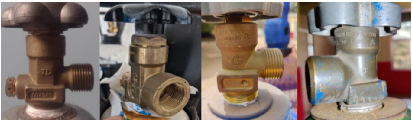
Diferentes válvulas do tipo “bullnose” para cilindros de oxigénio. Apesar de algumas parecerem quase idênticas, todas estas válvulas são de normas diferentes e não são compatíveis entre si.
