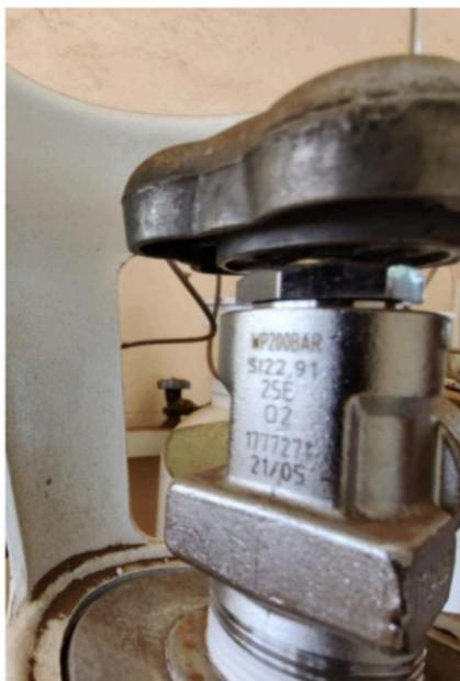
« SI 22.91 » fait référence au diamètre extérieur et à la forme du filetage de sortie de la vanne. Les vannes britanniques n'utilisent pas cette désignation.
