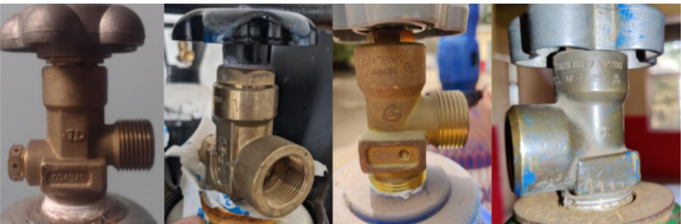
Différentes valves à nez arrondi pour l'oxygène. Même si certaines semblent presque identiques, toutes ces valves sont issues de normes différentes et non compatibles. L'équipement qui se connecte à une valve ne s'adaptera pas aux autres valves.
