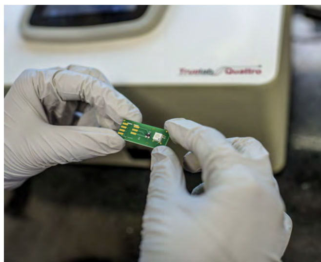
Un técnico de laboratorio prepara un chip con una muestra para el diagnóstico de la COVID-19 utilizando una herramienta de diagnóstico de última generación, que permite realizar pruebas bidireccionales para la COVID-19 y la tuberculosis. El Fondo Mundial/Atul Loke/Panos
